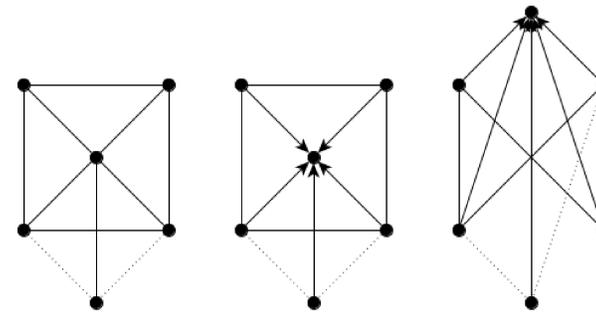
Figura 2:  $R^*$ , orientação do  $R^*$  com os arcos apontando para o vértice central e como isso força o grafo a não ter mínimo. As arestas tracejadas podem ou não existir.
